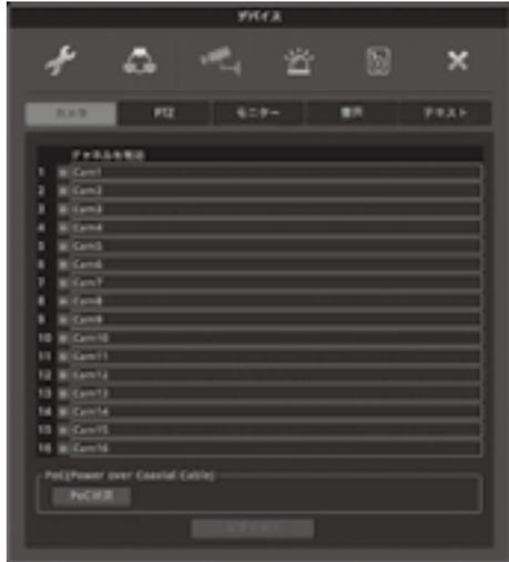
**チャンネルを有効**：使用するカメラチャンネルをチェックします。チェックを外すとカメラを接続しても映像が出ません。録画もできなくなります。
