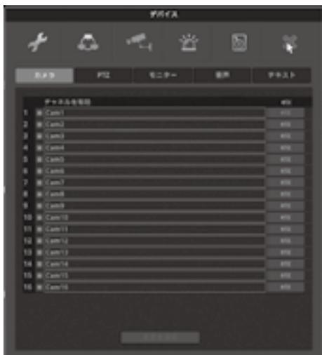
チャンネルを有効：使用するカメラチャンネルをチェックします。
