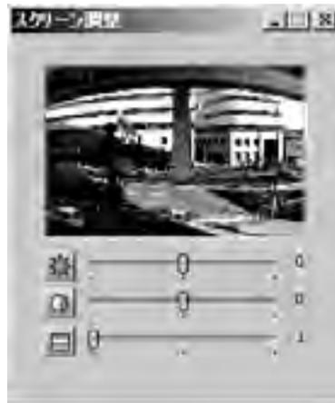
映像の停止状態で調整したいチャンネルを選択し、ツールバーの[画像]-[画像調整]または、ボタンをクリックすると、選択した画面がスクリーン調整画面に表示されます。
