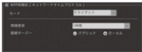
モード：[クライアント]、[サーバー]、[クライアント+サーバー] から選択します。
