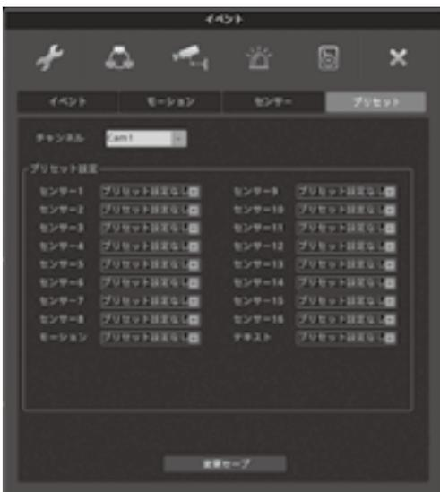
PTZ機能において、本機DVRとPTZカメラがDVR上で制御できるようになっている場合のみの設定です。センサーまたはモーション検出した時、PTZカメラの指定したプリセット番号へカメラを制御することができます。
